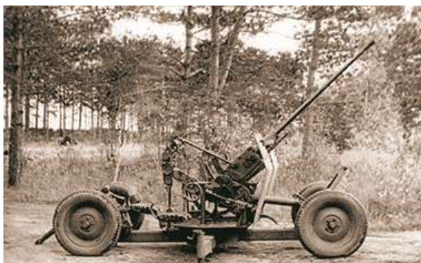
25-мм автоматическая зенитная пушка 72-К.
