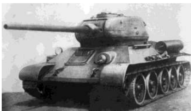
85-мм пушка ЗИС-С-53 обр. 1944 г. для танка Т-34-85.
