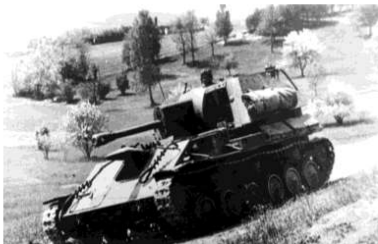
Самоходная установка СУ-76 с 76-мм пушкой ЗИС-3 обр. 1943 г. на исходной позиции в предгорьях Карпат, 1944 г.
